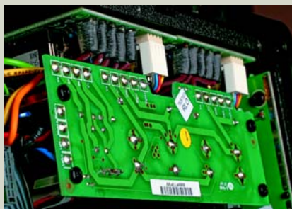
Końcówki mocy wykonano w formie dwóch modułów, dwu- i trzykanałowego.
