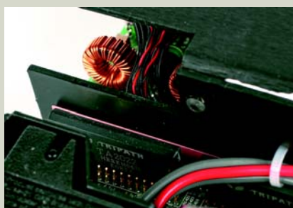
Moduły impulsowe końcówek mocy w systemie Tripath.
