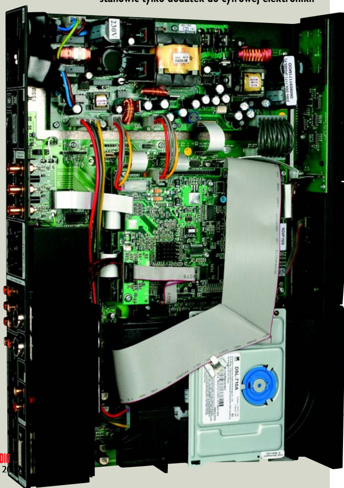
Moduły impulsowe końcówek mocy w systemie Tripath.
