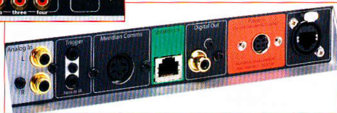
Speaker-Link: Die grüne Ethernet-Buchse am Control 10 dient zum Anschluss digitaler Aktiv-Lautsprecher. Die eigentliche Netzwerk-Schnittstelle sitzt rechts.
