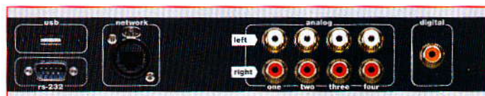
Multi-Room: Die vier Cinch-Pärchen auf der Rückseite des Ensemble können mehrere Hörzonen (Räume) versorgen. Der Digitalausgang (rechts im Bild) versorgt externe Wandler.
