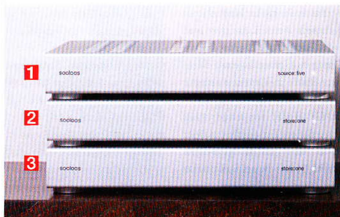
Team-Work: Ein Sooloos-Client wie der Source One (1) lässt sich per Netzwerk ganz einfach mit einem Server (2) verbinden. Reicht der Speicher nicht mehr aus, werden weitere Server (3) angeschlossen.
