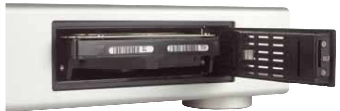
Schnell mal wechseln: Die Festplatte ist gut zugänglich, eine 1-TB-Harddisk ist bereits fertig verbaut
