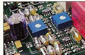
Dans l'électronique de sortie, la présence de condensateurs Styroflex ne laisse pas indifférent.
