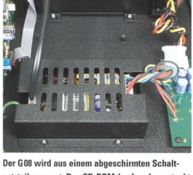
Der G08 wird aus einem abgeschirmten Schaltzetteil versorgt. Das CD-ROM-Laufwerk versteckt sich hinten unter einer Metallhaube
