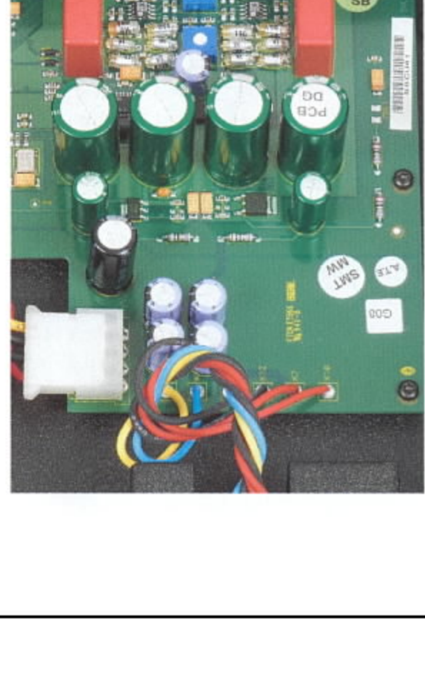
Die vollsymmetrisch ausgelegte Ausgangsstufe ist in klassischer Weise aufgebaut. Andere Platinen sind sechslagig und in SMD-Bauweise ausgeführt
