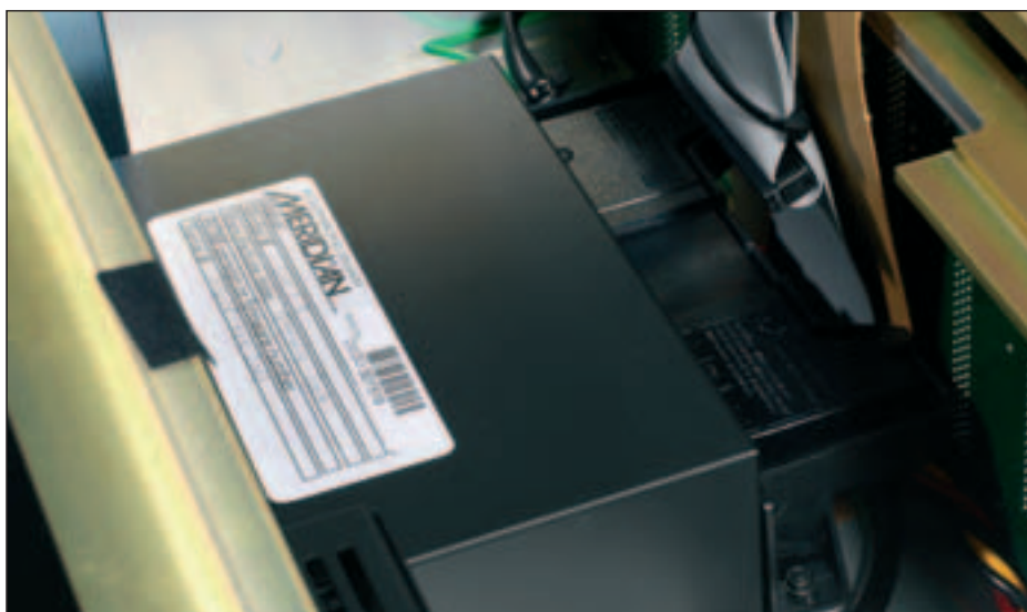
Guter Lauf: Die erste Daten-Auslese von der CD übernimmt ein gut gekapseltes DVD-ROM-Laufwerk, das übrigens in allen optischen Meridian-Playern zum Einsatz kommt.
