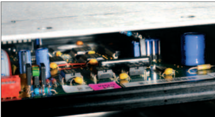
Ein Blick in die Tiefe: Die senkrecht montierte Platine ganz rechts am Motherboard beherbergt die Systemintelligenz. Sie managt den Player und seine Rechenoperationen.
