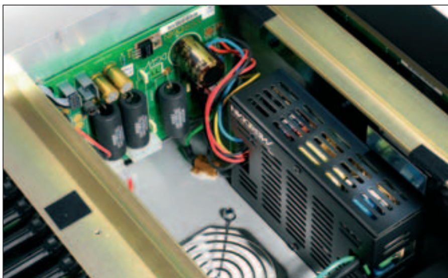
Klein, aber oho: Im strahlungshemmenden Metall-Käfig findet das kompakte, clever konzipierte Schaltnetzteil seine Heimstatt. Riesige Trafos oder Elkos braucht es nicht.
